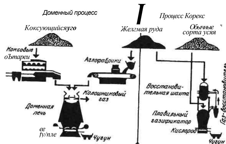
Рис. 71. Сравнение процессов доменного и COREX
