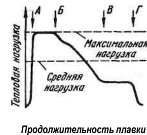
Рис. 108. Схема изменения тепловой нагрузки по ходу плавки в мартеновской печи: А — начало завалки и прогрева твердой шихты; Б — начало заливки жидкого чугуна; В — полное расплавление шихты; Г — выпуск
